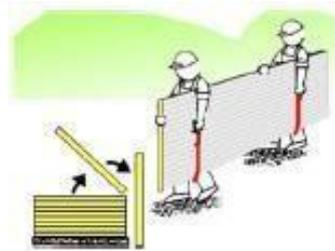
**5.4.3** En el caso de una pared con salida con una altura máxima de 1,50mts del plan de arranque y paneles de largo entre los 4 a 6 mts, el levantamiento se puede ejecutar simplemente a mano o con el auxilio de una soga con protección (Ej.: Corcho, goma, etc) evitando dañar el panel.
