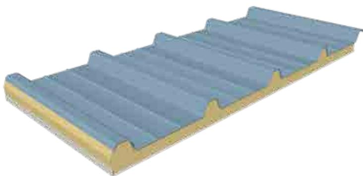
Panel de acero fabricado en proceso de línea continua con **núcleo de poliuretano (PUR) o poliisocianurato (PIR) de alta densidad**. Cara exterior en chapa galvanizada, prepintada o cincalum y cara interior foil de polipropileno.
