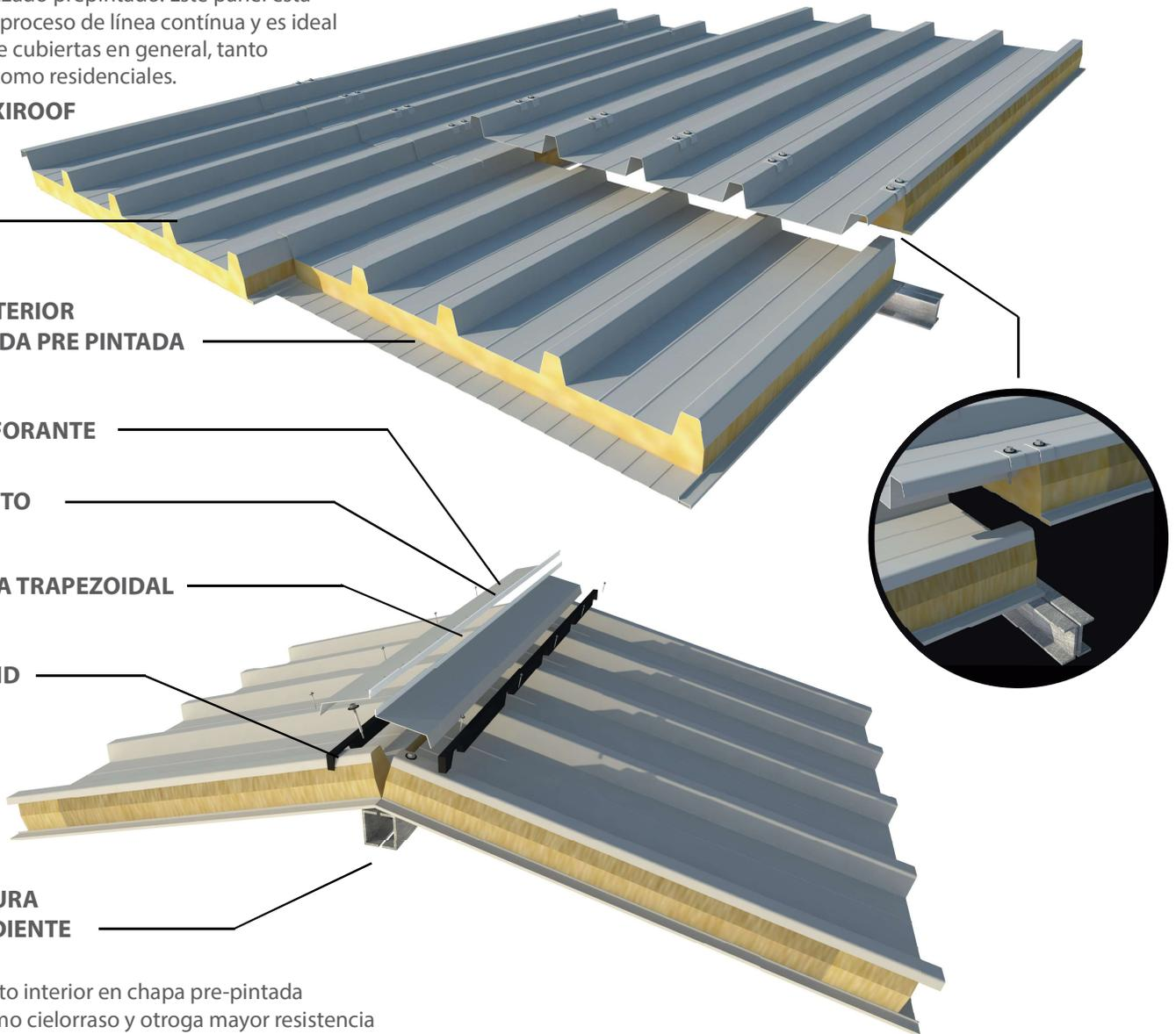
Revestimiento interior en chapa pre-pintada utilizada como cielloraso y otorga mayor resistencia aumentando luz de apoyo.
